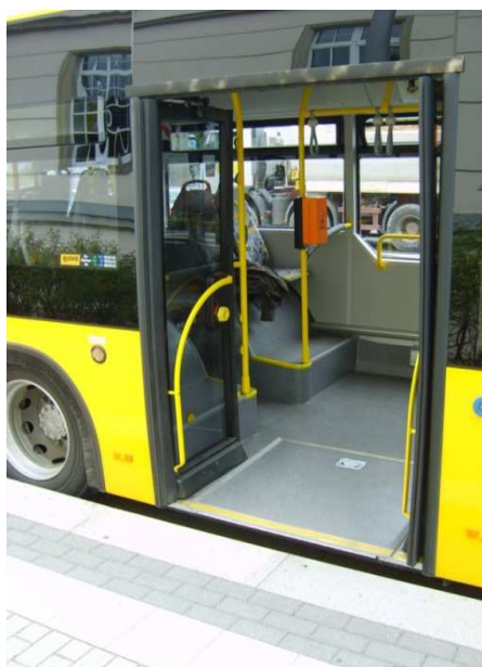
Rys. 9.8.2.2. Przerwa między peronem przystankowym a autobusem. Źródło: opracowanie własne.
