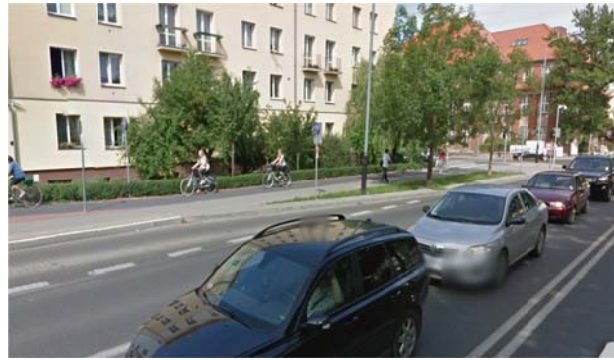
Rys. 2.16 Przykład drogi rowerowej odseparowanej zielenią od ruchu samochodów oraz konstrukcyjnie od pieszych [6]
