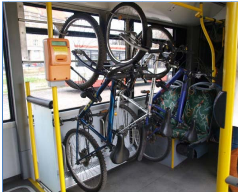
Rys. 2.49 Przykład wyposażenia autobusu w specjalne haki na rowery - Gdańsk
