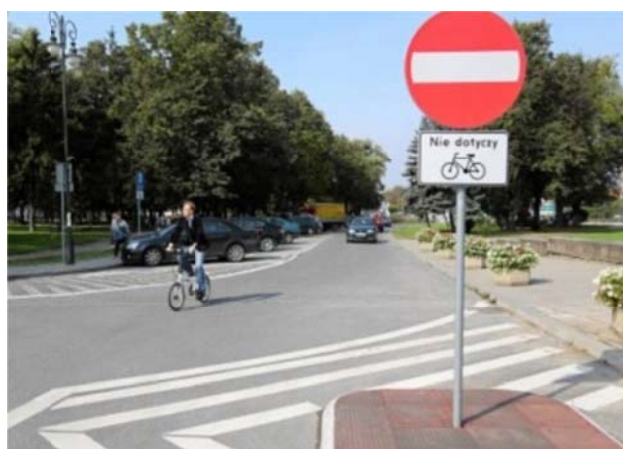
Rys. 2.4 Przykład dopuszczenia ruchu „pod prąd” dla rowerów [13]
