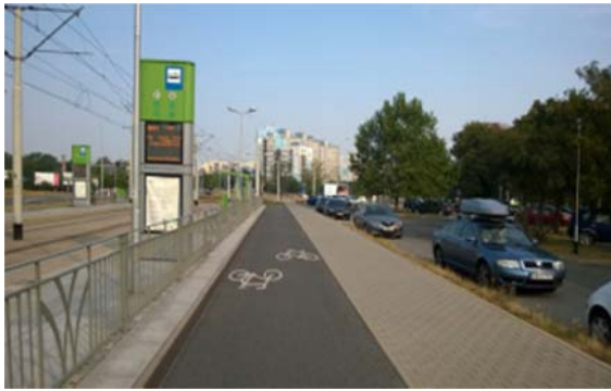
Rys. 2.16 Przykład drogi rowerowej odseparowanej zielenią od ruchu samochodów oraz konstrukcyjnie od pieszych [6]
