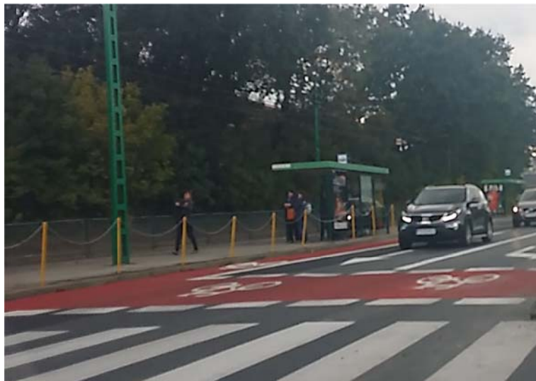
Rys. 2.8 Pierwsza w Poznaniu śluza rowerowa – ul. Pułaskiego, 2015r.
