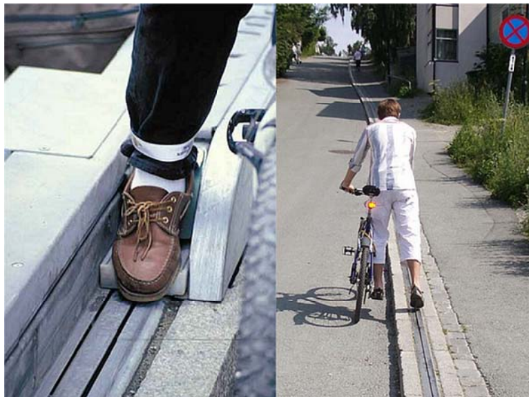
Rys. 2.43 Przykład zastosowania wyciągu dla rowerów – Trondheim [17]
