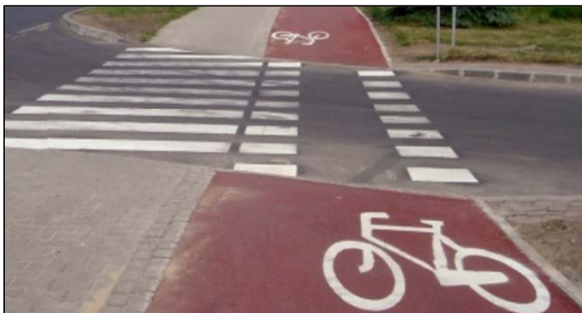
Rys. 2.45 Przykład przejazdu rowerowego przy przejściu dla pieszych
