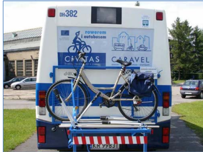
Rys. 2.48 Przewóz rowerów na zewnątrz autobusu – Kraków [10]
